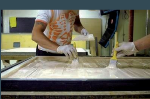
工人正在将A1三轴纤维涂覆在模具上。
