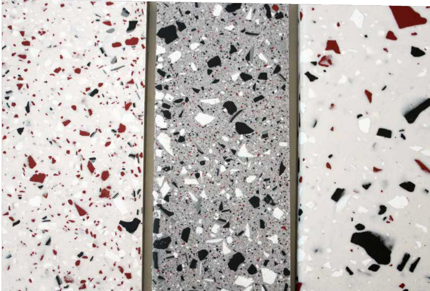
在混合的A1中添加不同颜色的破碎A1并搅拌均匀。
