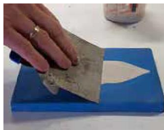
将所需量的A1倒入模具中，用油灰刀将多余的A1刮铁。
