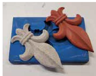
干燥和卸载后的结果：坚固的铸造物体，模具的精确副本。
