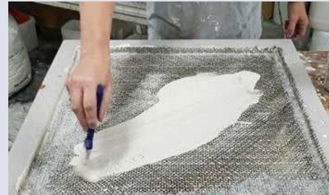
要层压，你必须湿润工作。应用A1的快速方法是使用刷子或滚筒。
