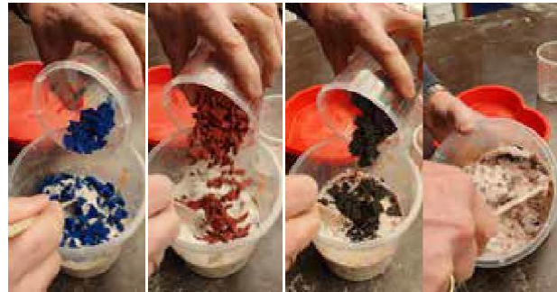
在混合的A1中添加不同颜色的破碎A1并搅拌均匀。
