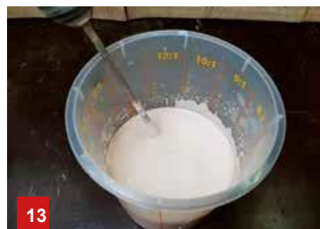
10 将搅拌器（歪斜）放入A1液体杯中并产生漩涡。
