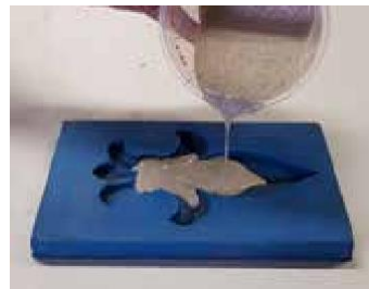
将部分创建的A1倒入模具中。首先（如果可能）先刷模具，然后用A1触摸所有凹凸。
