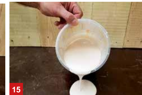
15 A1 可用于层压、铸造或喷涂。处理时间 20 - 25 分钟。
