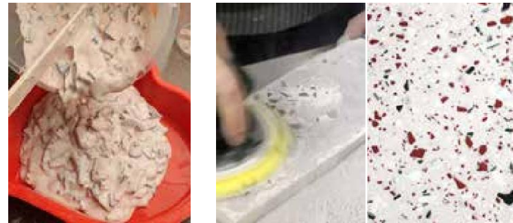
涂在模具中，让A1固化。从模具中脱模后的打磨。
