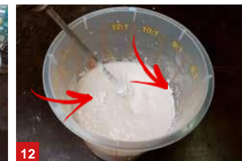
12 搅拌混合器，直到所有块状物消失（± 1 分钟），从而形成光滑的材料。
