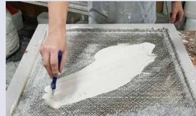
要进行层压，您必须在潮湿的环境中工作。快速应用A1的方法是用刷子或滚筒。
