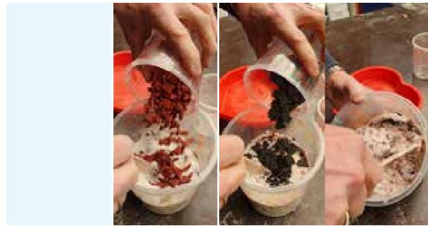
将不同颜色的破碎A1加入混合后的A1中并充分搅拌。
