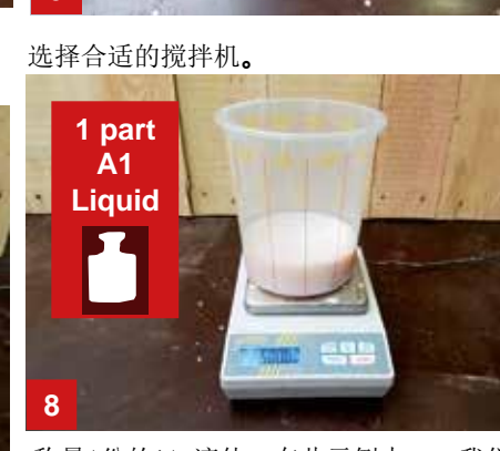
8 称量1份的A1 液体。在此示例中，我们使用 500 g A1 液体。
