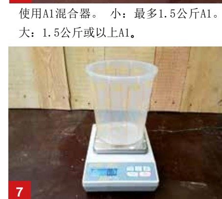
7 将杯子放在秤上。与杯子一起校准秤（0.0克）。
