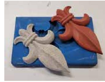
干燥和卸载后的结果：实心铸件，模具的精确副本。
