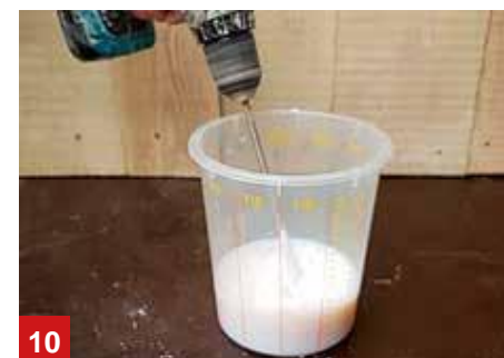
10 将混合器（倾斜）放入 A1 液体杯中，并创建一个漩涡。
