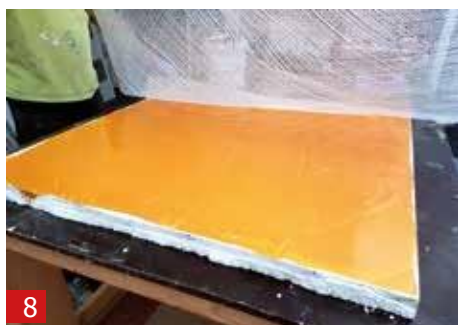
8 在仍然潮湿的情况下，直接在A1上用±1平方米的三轴纤维。
