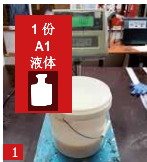
1 校准秤并称重1000克A1液体...
