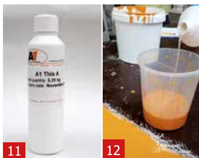
11 向剩余的A1中添加1%的Thix A，并用搅拌棒充分搅拌。A1会变厚。
