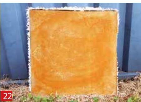
22 将面板放在外面使其生锈。为了获得更强烈的铁质外观，请将面板放在外面更长的时间。也可以使用化学药品来加快这一过程。
